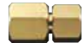
CZ-MA1P Um die Anschlussgröße am Innengerät gasseitig auf 9,52 mm zu verringern, muss das Reduzierstück CZ-MA1P verwendet werden.
